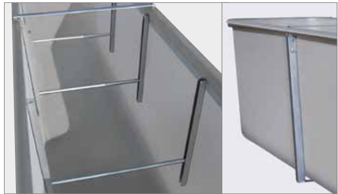
Großbehälter: Innenstreben aus Edelstahl für den Einbau ins Erdreich, Außenstreben feuerverzinkt für die oberirdische Aufstellung
