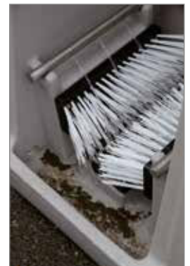
Sammelwanne zum Sammeln und Ableiten des Schmutzwassers
