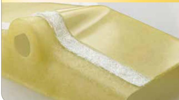
Aufgrund der herausragenden Werkstoffeigenschaften, die durch die Armierung des dreidimensional vernetzten Duroplastmaterials mit Glasfasern entstehen, werden aus GFK seit Jahrzehnten Produkte für hohe Beanspruchung hergestellt, von denen eine lange Lebensdauer in rauer Umgebung und gleichzeitig hohe Sicherheit erwartet wird. GFK verbindet die positiven Eigenschaften von Stahl und Kunststoff.
