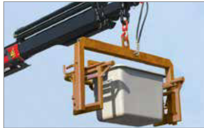
Anheben des Behälters (Beispiel mit Streugutbehälter 200 l)
