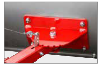
Steuerung für drei/fünf Schildpositionen
