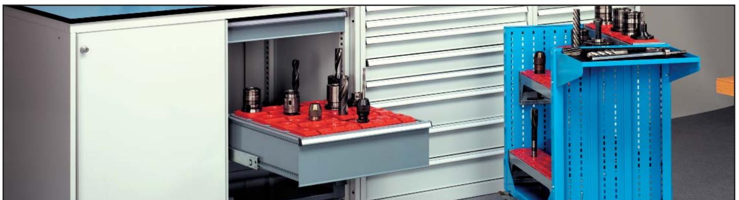
Die Schränke müssen am Fußboden oder an der Wand befestigt werden.
